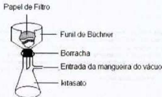
Figura 2: Ilustração da filtração para separação dos cristais de cafeína.
