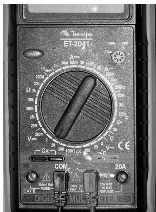
Figura 60 - Escala de 20V para corrente contínua.
