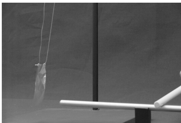
Figura 16 – O bastão de alumínio conduz a carga elétrica do bastão de PVC para a folha de alumínio.
