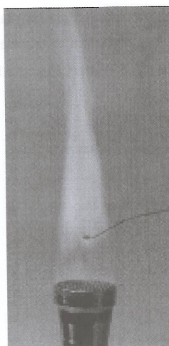
FIGURA 3 - Teste de chama para potássio (violeta) Fonte: WHITTEN, 1996.
