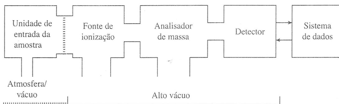
FIGURA 8.1 Componentes de um espectrômetro de massa. Fonte: Gross (2004). Reprodução autorizada.
