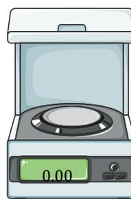
**Balança:** utilizada para pesagem. Deve estar nivelada e ter manutenção e calibração periódica.
