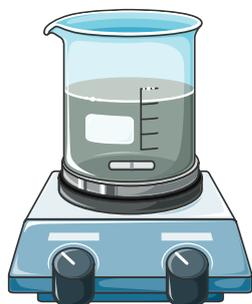
**Agitador magnético com ou sem aquecimento:** agitação de líquidos com auxílio de uma barra magnética movida por um campo magnético rotativo.
