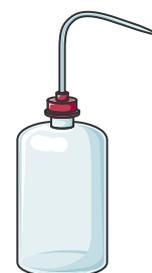
**Pisseta ou frasco lavador:** lavagem de diversos materiais. Em geral, contém água destilada, mas outros solventes podem também ser armazenados.
