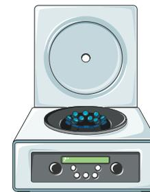
**Centrífuga:** separação de misturas imiscíveis do tipo sólido-líquido, quando o sólido se encontra disperso no líquido.
