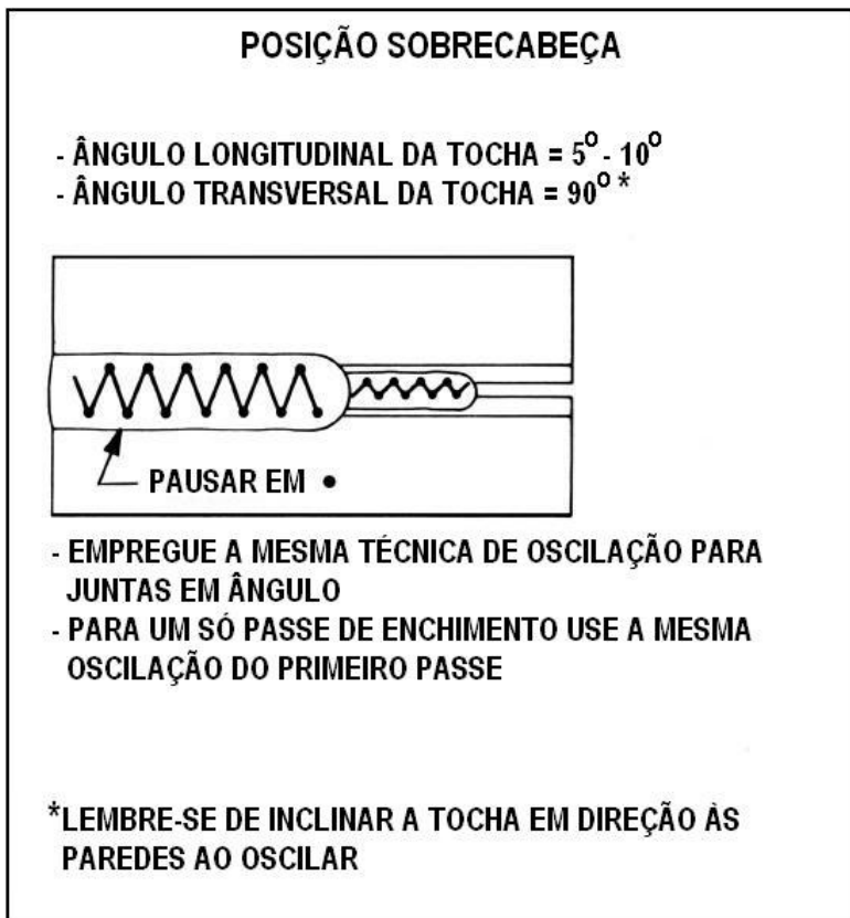
Figura 38 - Manipulações da tocha na posição sobrecabeça
