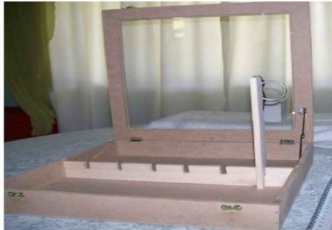
Figura 4 - Vista geral do objeto no perspectógrafo didático
