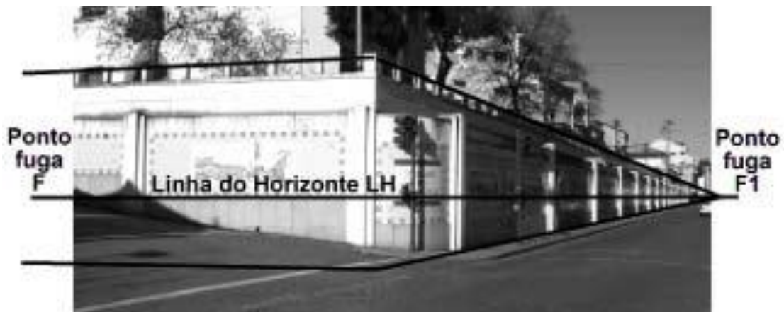
Figura 17 - Perspectiva com dois pontos de fuga: perspectiva oblíqua
