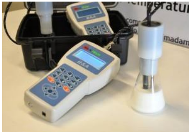
Figura 2 –Milktech: Equipamento desenvolvido no Grupo de Engenharia e Espectroscopia de Materiais da UFJF.
