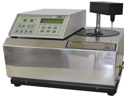
Figura 1- Imagem do crioscópio utilizado como medidor de referência da crioscopia e adição de água.
