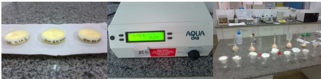
Figura B.7. Algumas análises, exemplo: atividade de água ( a_w ) e preparação para frações proteicas do QMA.
