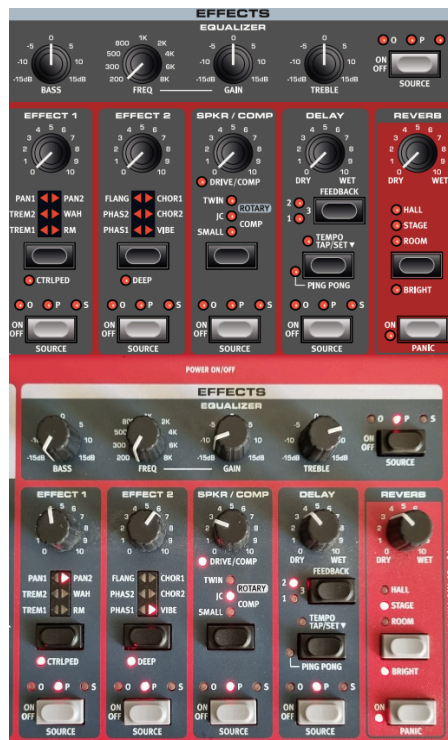
Figura 5 - Comparação entre o diagrama dos efeitos do teclado e uma fotografia da interface real, destacando as seis seções de efeitos embutidos no Nord Electro 6D, modelo de 73 teclas semi-pesadas.
