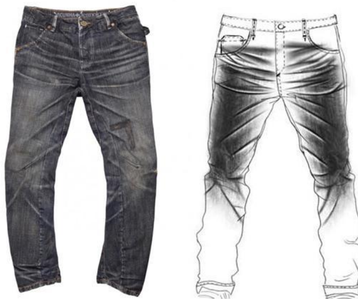
Figura 17: Calça Jeans pronta com efeitos de desgastes e bigode feito no laser / Projeto com a arte do desenho pretendido.
