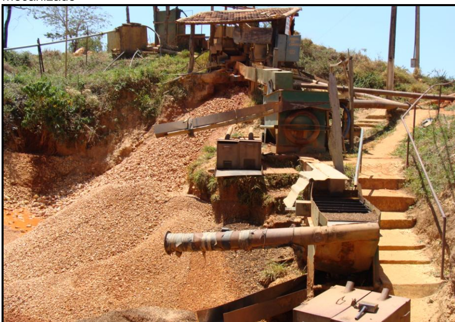
Imagem 3 - Montagem de jigue de cooperados da COOPERAGC em Santo Inácio, onde a lavagem de cascalho é realizada no processo mecanizado
