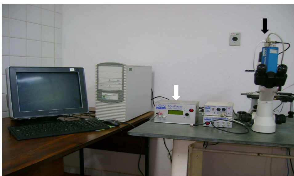
Figura 3. Sistema utilizado para aquisição dos registros das contrações dos miócitos cardíacos. Observam-se o microscópio com câmera acoplada (seta preta), o estimulador elétrico (seta branca) e o microcomputador.
