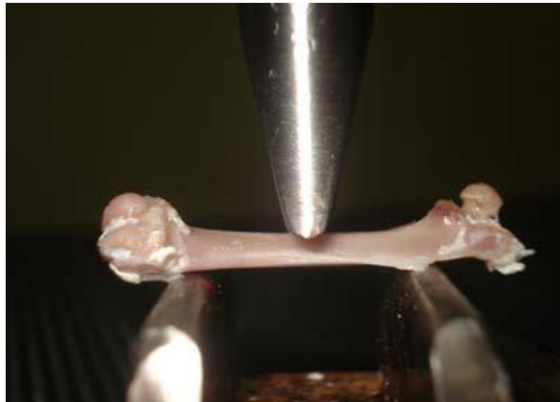
Figura 1. Fotografia do ensaio mecânico de flexão em três pontos, em diáfise de fêmur.
