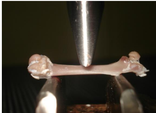
Figura 2. Fotografia do ensaio mecânico de flexão em três pontos, em diáfise de fêmur de rato.
