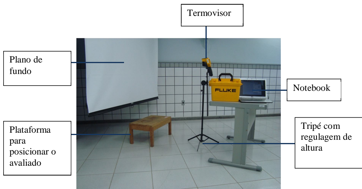
Figura 2. Visão da sala de coleta de dados termográficos com seus equipamentos.
