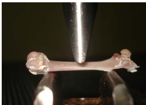
Figura 3: Fotografia do ensaio mecânico de flexão em três pontos, em diáfise de fêmur de rata.
