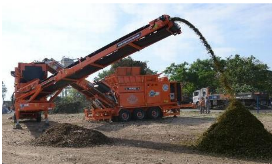
Figura 11: Equipamento utilizado para trituração de resíduo de poda.
