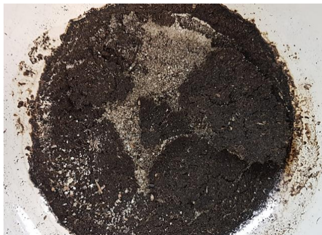
Figura 17: RSU compostado retido na peneira n° 200 após secagem em estufa.
