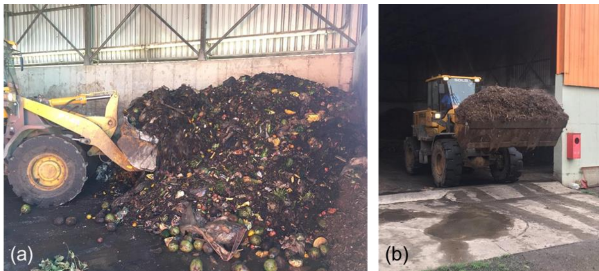
Figura 7: Fração orgânica dos resíduos sólidos antes (esquerda) e após (direita) o processo de metanização no TMethar.
