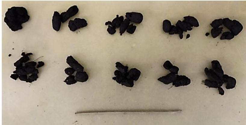
Figura 21: Ensaio de limite de plasticidade – RSU compostado.
