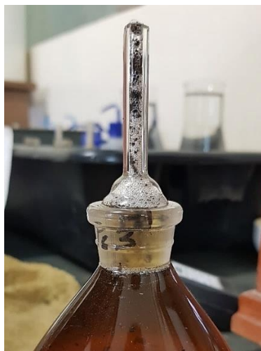
Figura 19: Obstrução na tampa do picnômetro.
