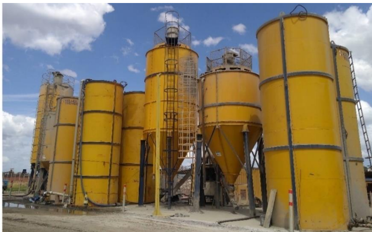
Figura 4.5 - Conjunto de equipamentos de apoio para a fabricação da calda de ligante.
