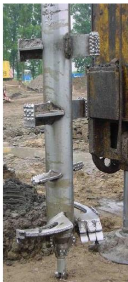
Figura 4.10 - Ferramenta de DSM com um eixo e 4 lâminas montadas ao longo do diâmetro ( \sum M = 8 ).
