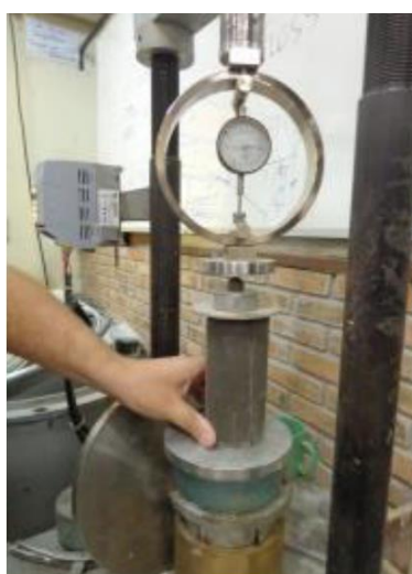
Figura 4.15 - Ensaio de resistência à compressão simples em corpo de prova de material oriundo de uma coluna DSM.
