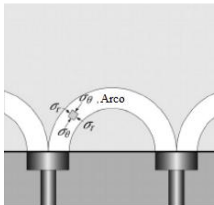
Figura 2.11 - Família dos modelos de equilíbrio limite ( \sigma_r e \sigma_\theta representam, respectivamente, as tensões axial e radial).
