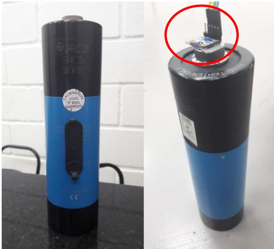
Figura 6.4 Calibrador PCB 394C06
