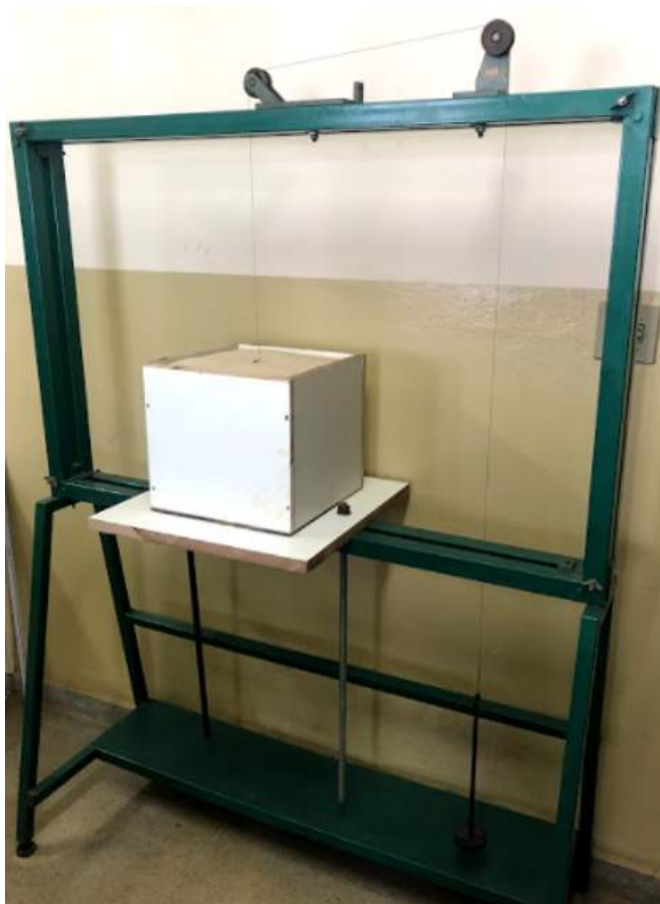
Figura 63 – Estrutura para realização de ensaio de arrancamento em modelos reduzidos de estacas
