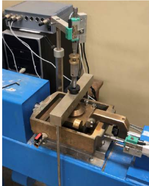
Figura 58 – Caixa com corpo de prova posicionada no interior da prensa de cisalhamento e sistema de leitura de dados dos ensaios
