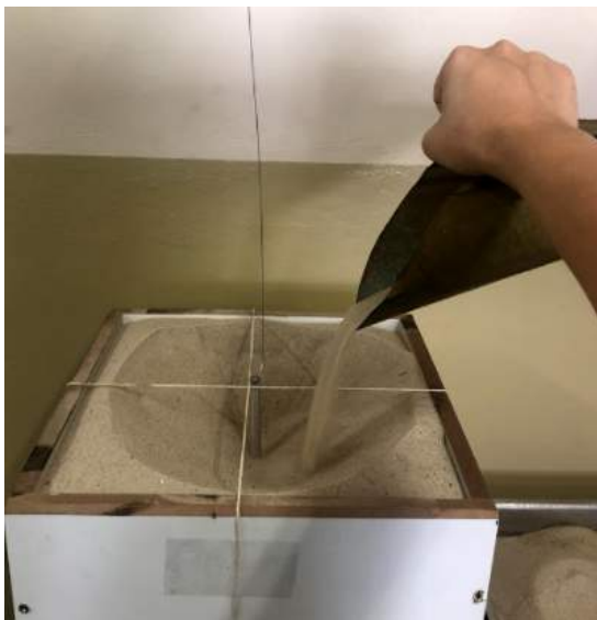
Figura 65 – Preenchimento da caixa com areia após posicionamento da estrutura
