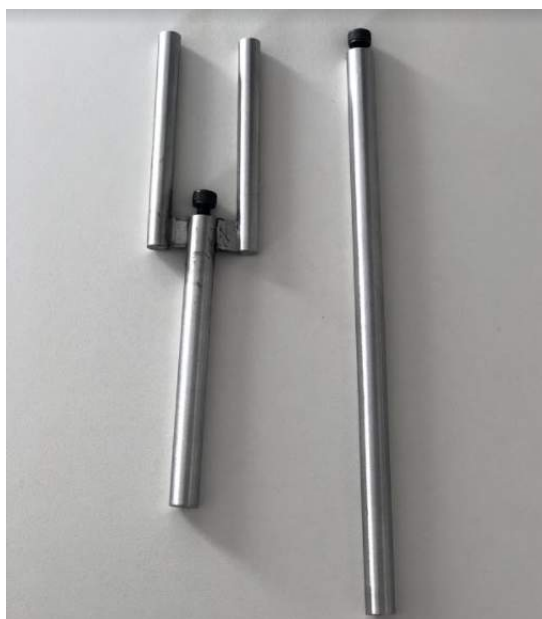
Figura 64 – Estacas ramificada (a esquerda) e convencional (a direita) confeccionadas em alumínio
