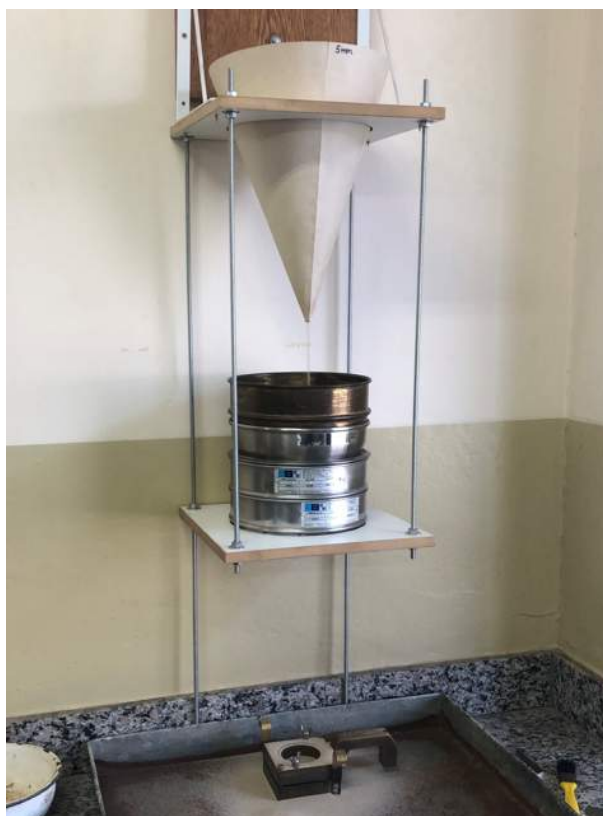
Figura 57 – Esquema de pluviação da areia no interior da caixa de cisalhamento
