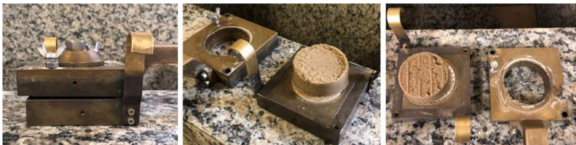
Figura 59 – Caixa e corpo de prova após a realização do cisalhamento
