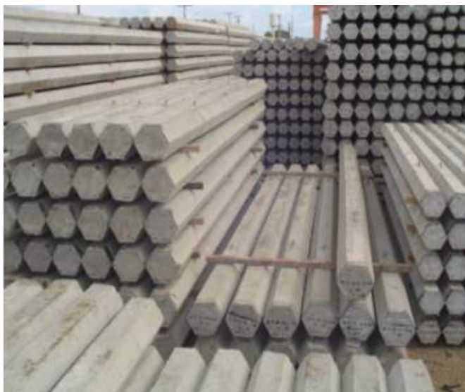
Figura 4 – Pátio de estocagem de estacas pré moldadas em concreto
