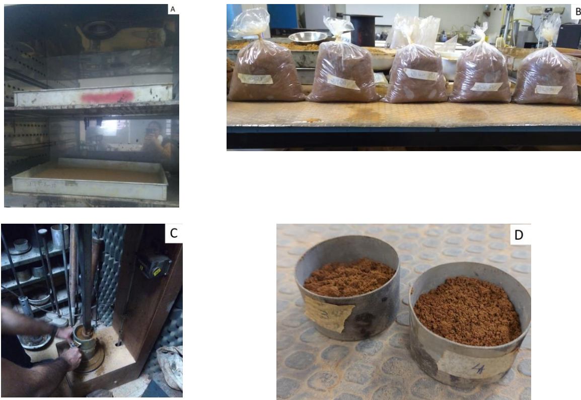
Figura 29- Procedimentos ensaio de compactação: (A) Solo destorroado (B) Amostra homogeneizadas com os cinco pontos de umidade (C) Compactação de um corpo de prova (D) Amostra do corpo de prova a ser levado para a estufa.
