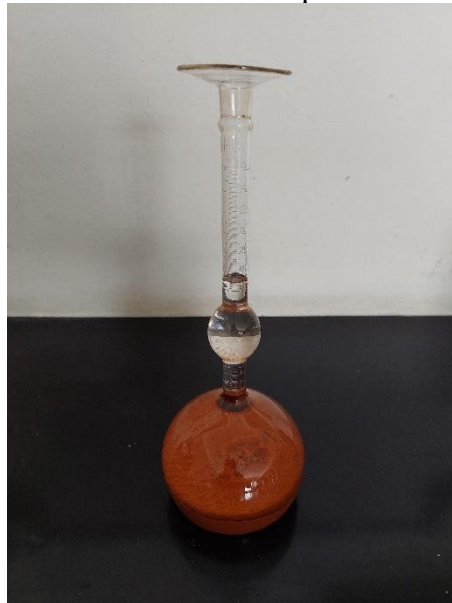
Figura 17 - Ensaio de massa específica da cerâmica
