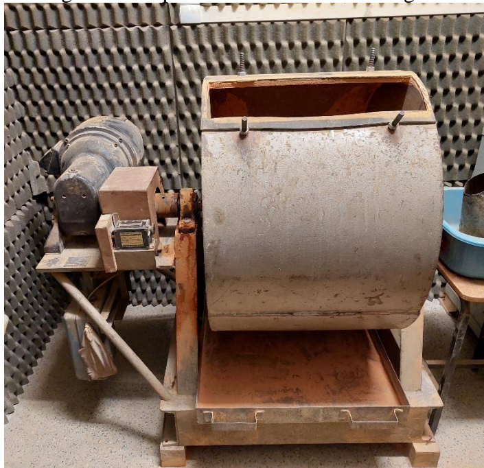
Figura 15 - Aparelho de Abrasão Los Angeles
