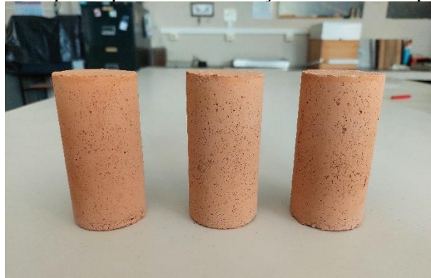
Figura 20 - Corpos de prova para a determinação da atividade pozolânica com cal
