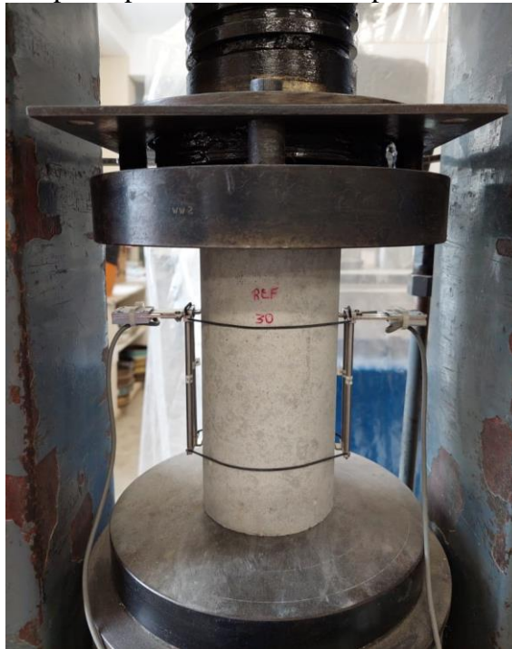
Figura 27 - Corpo de prova instrumentado posicionado na máquina
