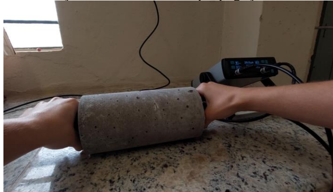
Figura 25 - Ensaio de medição da velocidade de propagação de onda ultrassônica
