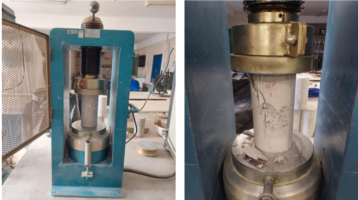
Figura 26 - Ensaio de resistência à compressão (a) Antes do rompimento (b) Após o rompimento
