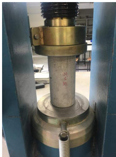
Figura 19 - Ensaio de resistência à compressão axial.
