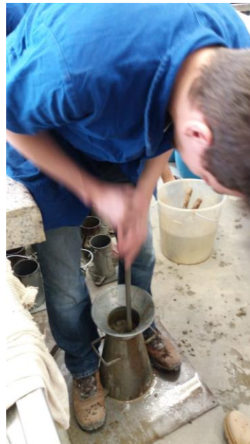
Figura 13 – Preenchimento do molde durante ensaio.
