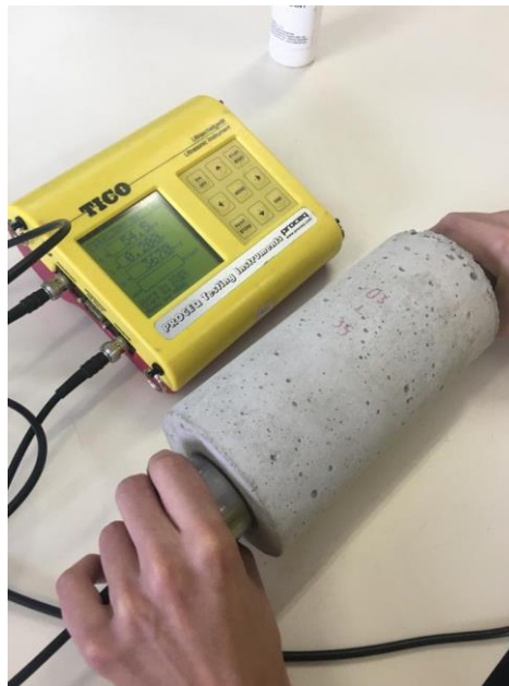
Figura 17 - Ensaio de velocidade do pulso ultrassônico.
