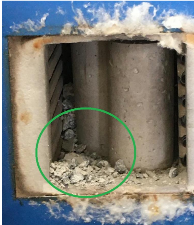
Figura 23 - Corpo de prova cilíndrico do tipo CS35 destruído completamente na mufla.
