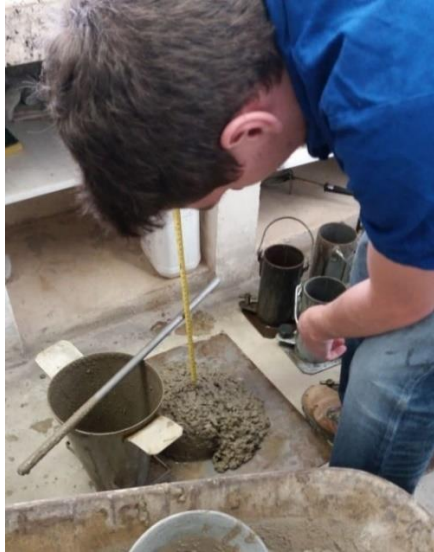
Figura 14 - Medição do abatimento.
