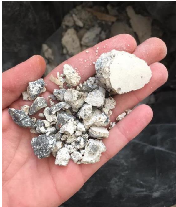
Figura 24 - Fragmentos do corpo de prova cilíndrico do tipo CR70.
