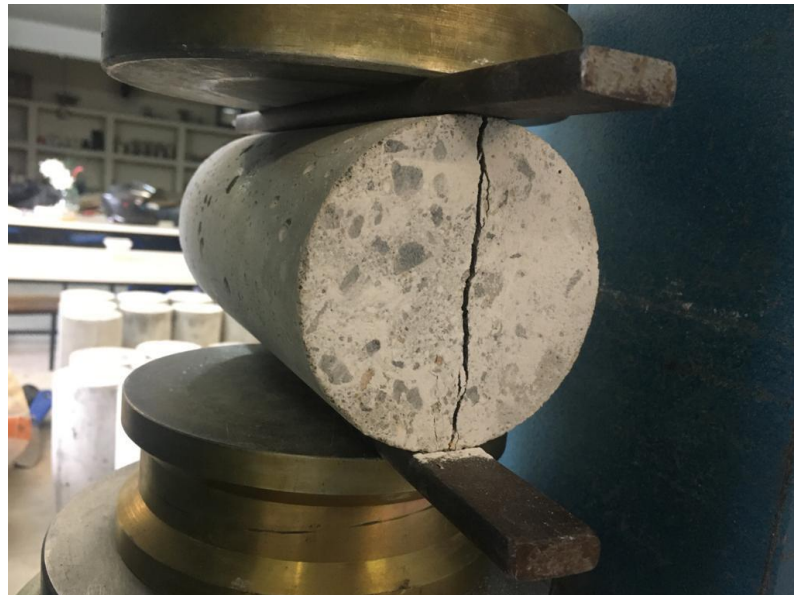
Figura 20 - Ensaio de tração por compressão diametral.
