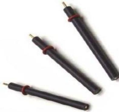
SISTEMA POTENCIOSTÁTICO COM TRÊS ELETRODOS
