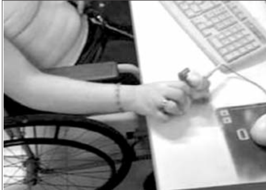
Foto 18 - Dispositivo em uso por meio de pressão com a mão
