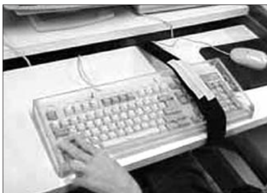
Foto 7 - Máscara de teclado encaixada
