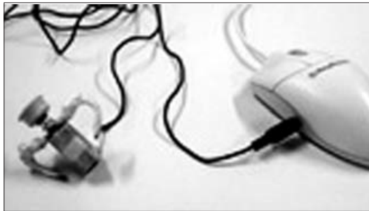
Foto 20 - Acionador confeccionado com botão liga/desliga de computador
