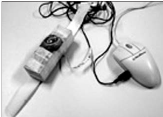
Foto 21 - Chave para acionamento com a cabeça, feita com botão grande de sucata
