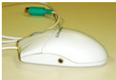
Figura 103: Mouse adaptado com plug
