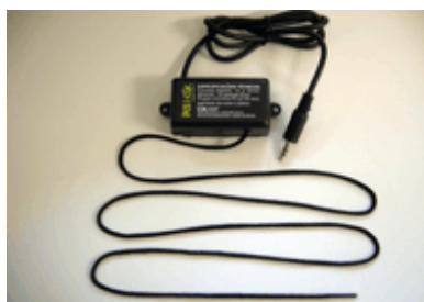
Figura 100: Acionador de Tração
