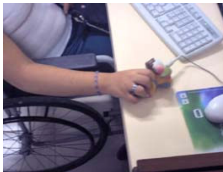
Figura 102: Dispositivo em uso através de pressão com a mão
