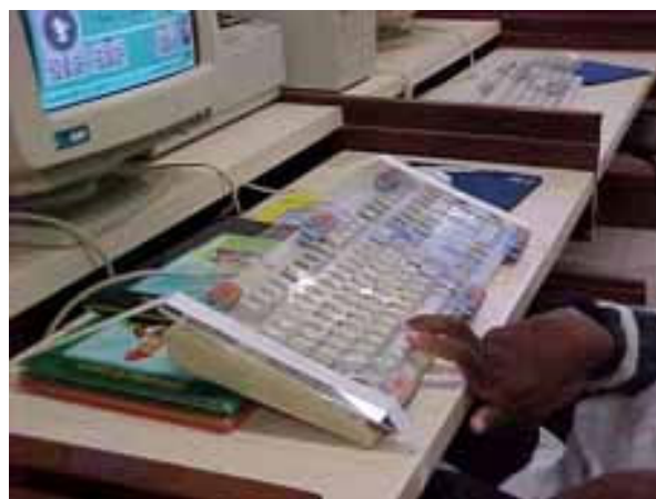
Figura 66: Teclado com alteração na inclinação e fixado à mesa
