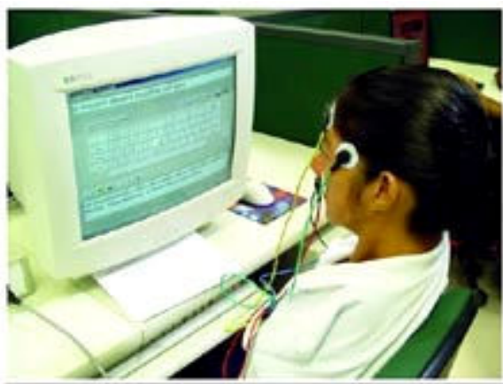
Figura 86: Utilizando o Mouse Ocular
