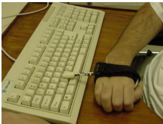
Figura 56: Adaptação para digitação
