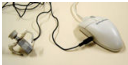
Figura 104: Acionador confeccionado com botão liga/desliga de computador
