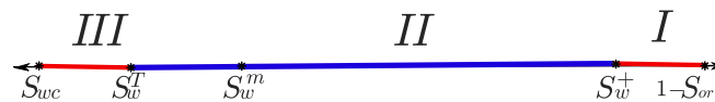
Figura 4.4 – Possíveis estados S_w^- indicando as regiões onde existe solução (cor azul) e não existe solução (cor vermelha) do tipo de ondas viajantes.
