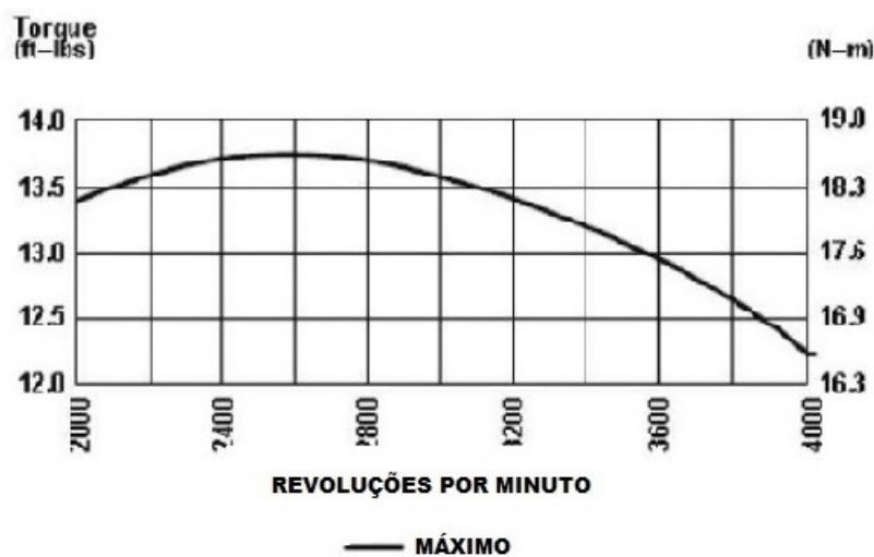
Figura 2 – Curva de torque do motor Briggs & Stratton 10 hp e 305 cc
