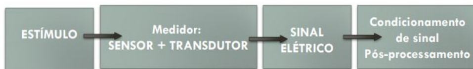
Figura 9 – Esquema ilustrativo sobre transdutores
