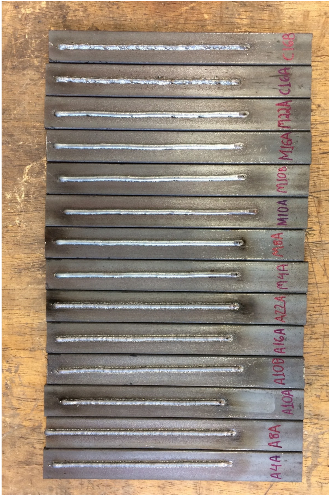
Figura 10: Cordões de solda Fonte: Do autor
