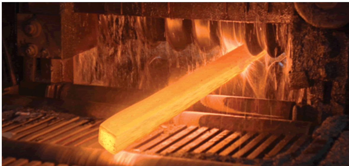
Figura 4 – Passagem do tarugo pelas gaiolas ao ser laminado [1]
