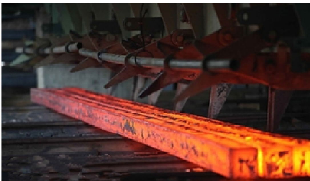
Figura 20 – Tarugos sendo aquecidos no interior do forno.[19]
