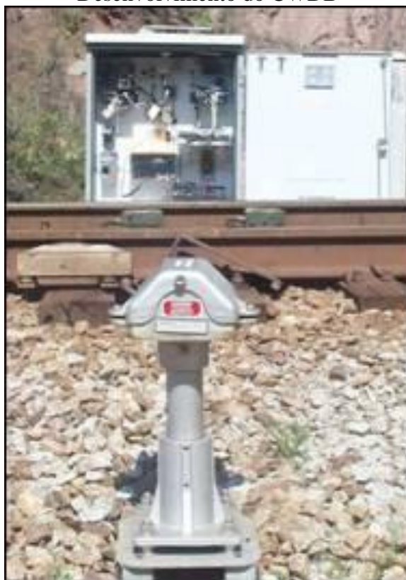
Figura 7 – Exemplo de Equipamento “ Hot Wheel ” Similar ao Utilizado Para o Desenvolvimento do CWDB
