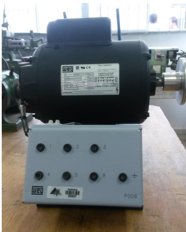
Figura 39 - Motor com 1750 rpm utilizado na primeira fase dos ensaios( Fonte: Autora)
