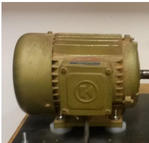
Figura 40 - Motor com 3400 rpm utilizado na segunda fase dos ensaios( Fonte: Autora)
