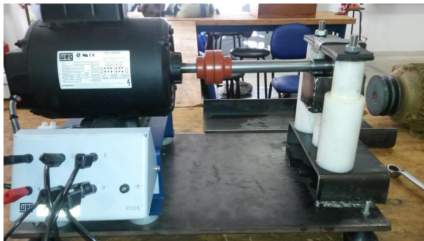
Figura 42 - Equipamento com o ensaio de banho de óleo e motor 1750 rpm( Fonte: Autora)
