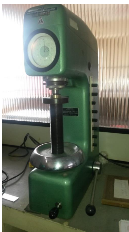
Figura 36 - Equipamento de Análise de Dureza Rockwell C do Laboratório de Resistência dos Materiais da Faculdade de Engenharia de Juiz de Fora
