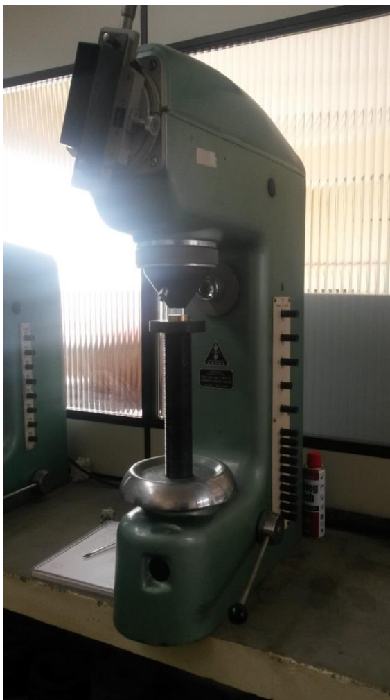
Figura 37 - Equipamento de Análise de Dureza Vickers e Brinell do Laboratório de Resistência dos Materiais da Faculdade de Engenharia de Juiz de Fora
