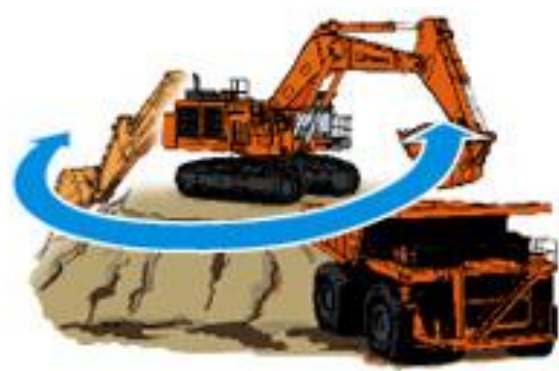
Figura 8 - Escavadeira girando a estrutura superior.
