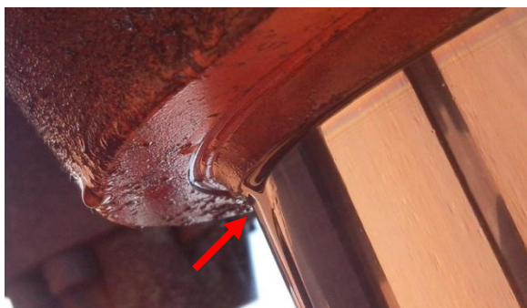
Figura 62 - Vazamento em cilindro.
