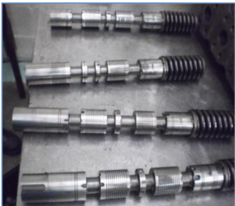
Figura 38 - Carretéis das válvulas.
