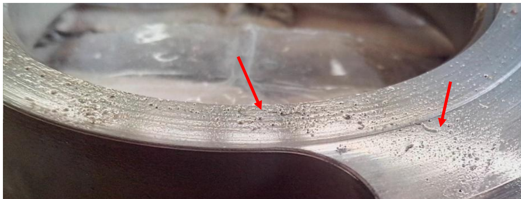
Figura 48 - Cavitação em placa de válvulas.
