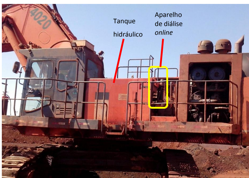
Figura 65 - FZ-2399 4020 em operação. Vemos a localização do tanque hidráulico e do aparelho de diálise.
