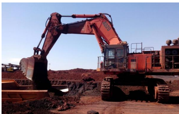
Figura 7 - Despejo de material em um caminhão.
