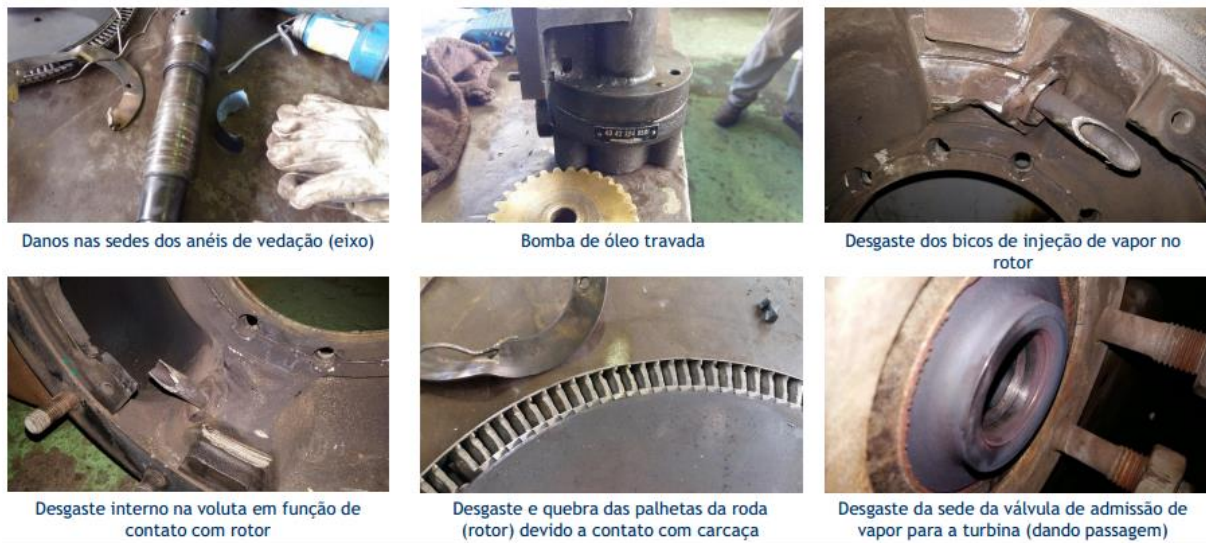
Figura 25. Componentes da turbina após desmontagem para investigação da falha. Fonte: fornecido pela empresa.
