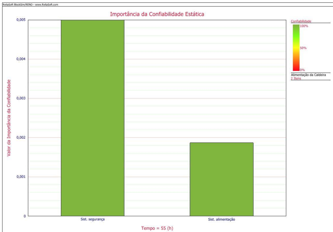
Figura 37. Importância de confiabilidade estática do sistema de alimentação de água da caldeira para 55 horas. Fonte: resultado de simulação pela ferramenta BlockSim do software Synthesis Platform.
