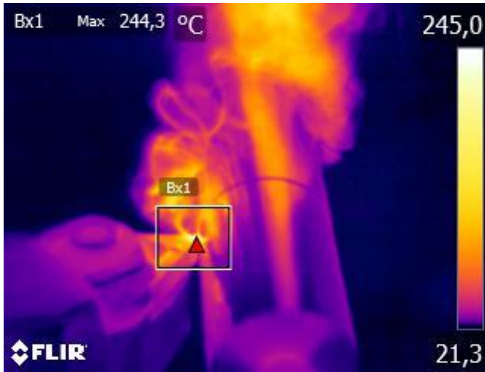
Figura 26 – Corpo de prova 3; n=1600 rpm; V_c=115,11 m/min; f=0,100 mm/rev; a_p=0,25 mm Fonte: Arquivo do aluno
