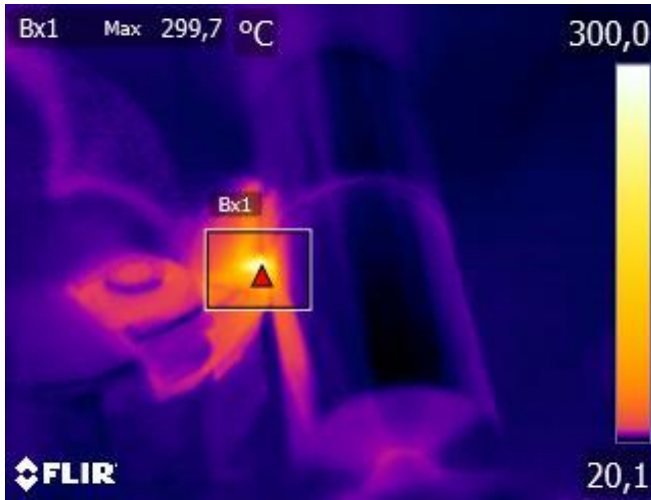
Figura 32 – Corpo de prova 6; n=1600 rpm; V_c=123,90 m/min; f=0,201 mm/rev; a_p=0,375 mm Fonte: Arquivo do aluno
