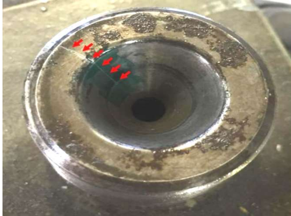
Figura 34: Trinca na sede do tubo de alta pressão, 0006 Fonte: Autor
