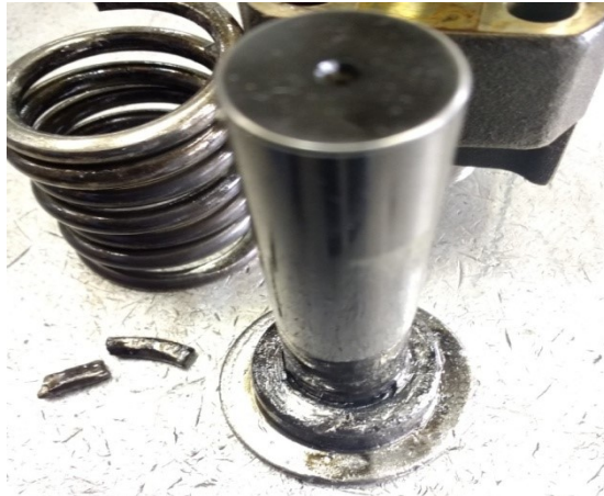
Figura 30: Fratura da Mola, 0002 Fonte: Autor
