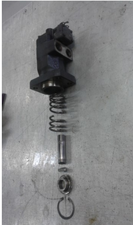
Figura 27: Componentes internos da bomba injetora fraturados Fonte: Autor
