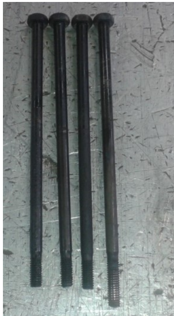
Figura 28: Quebra dos parafusos de fixação Fonte: Autor
