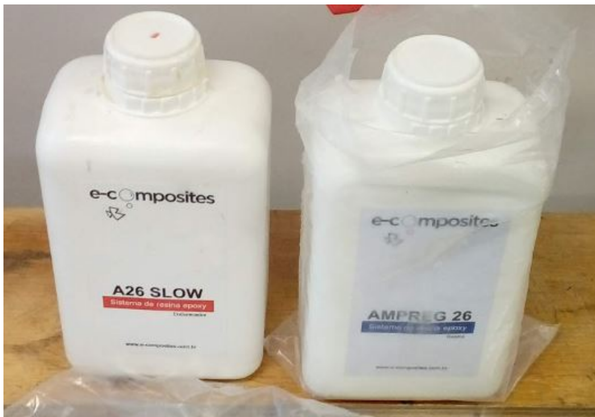
Figura 15 – Resina utilizada na fabricação da longarina.
