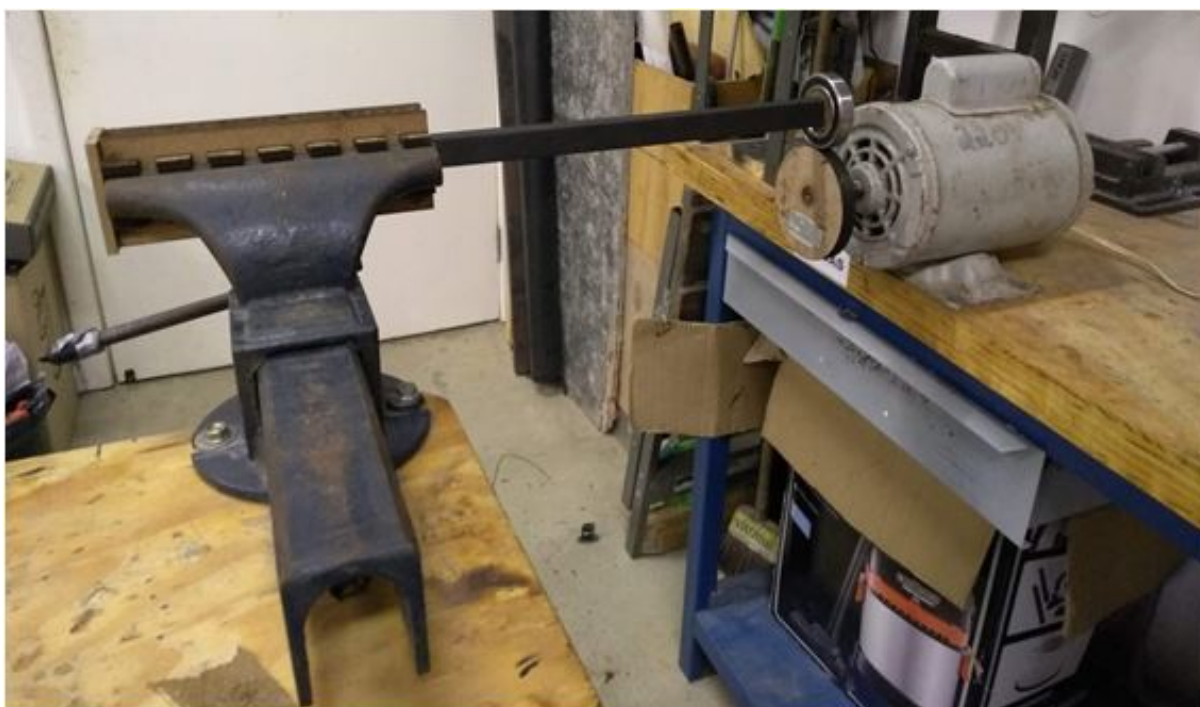
Figura 61 – Montagem do sistema de ensaio de fadiga
