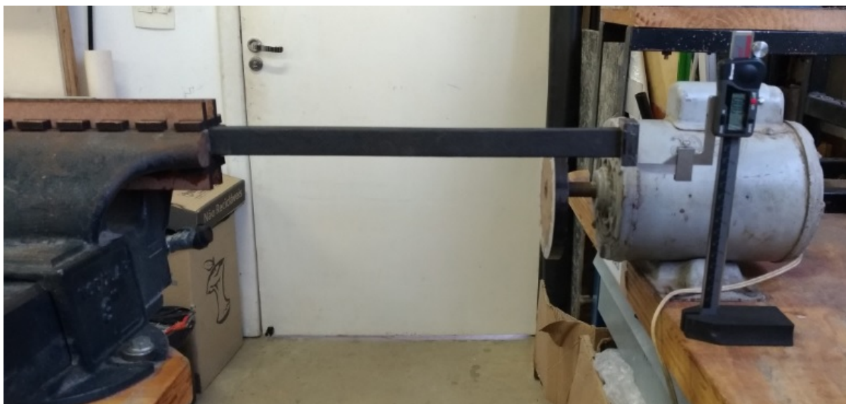
Figura 31 – Sistema para realização do ensaio estático.
