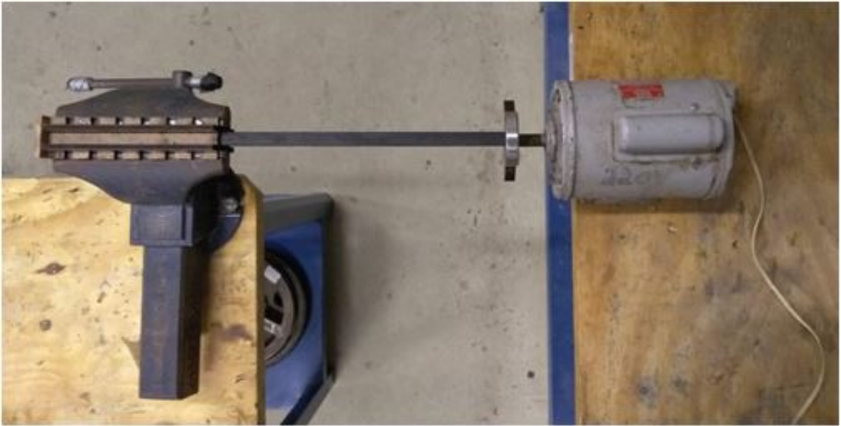
Figura 62 – Montagem do sistema de ensaio de fadiga, vista superior
