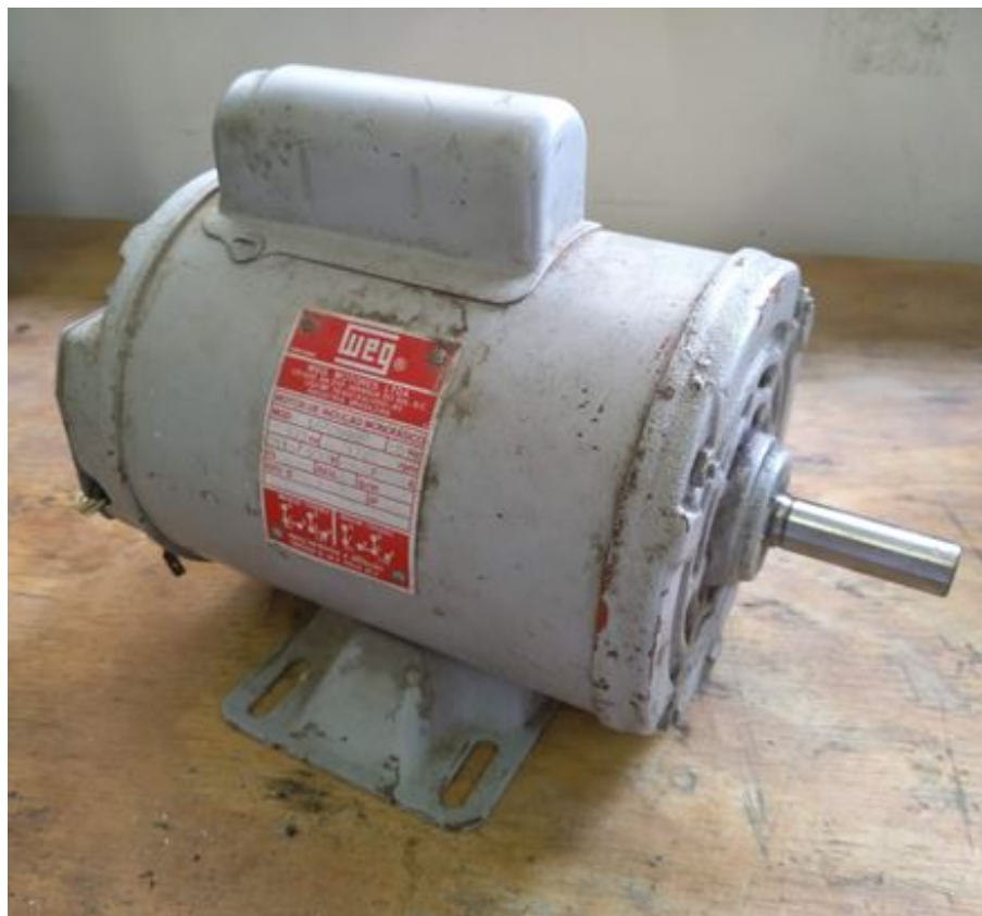
Figura 33 – Motor elétrico utilizado no ensaio de fadiga.
