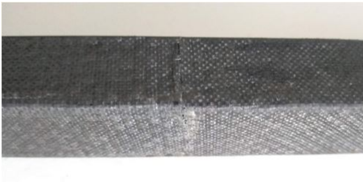
Figura 66 – Falha na face da longarina e propagação da trinca.
