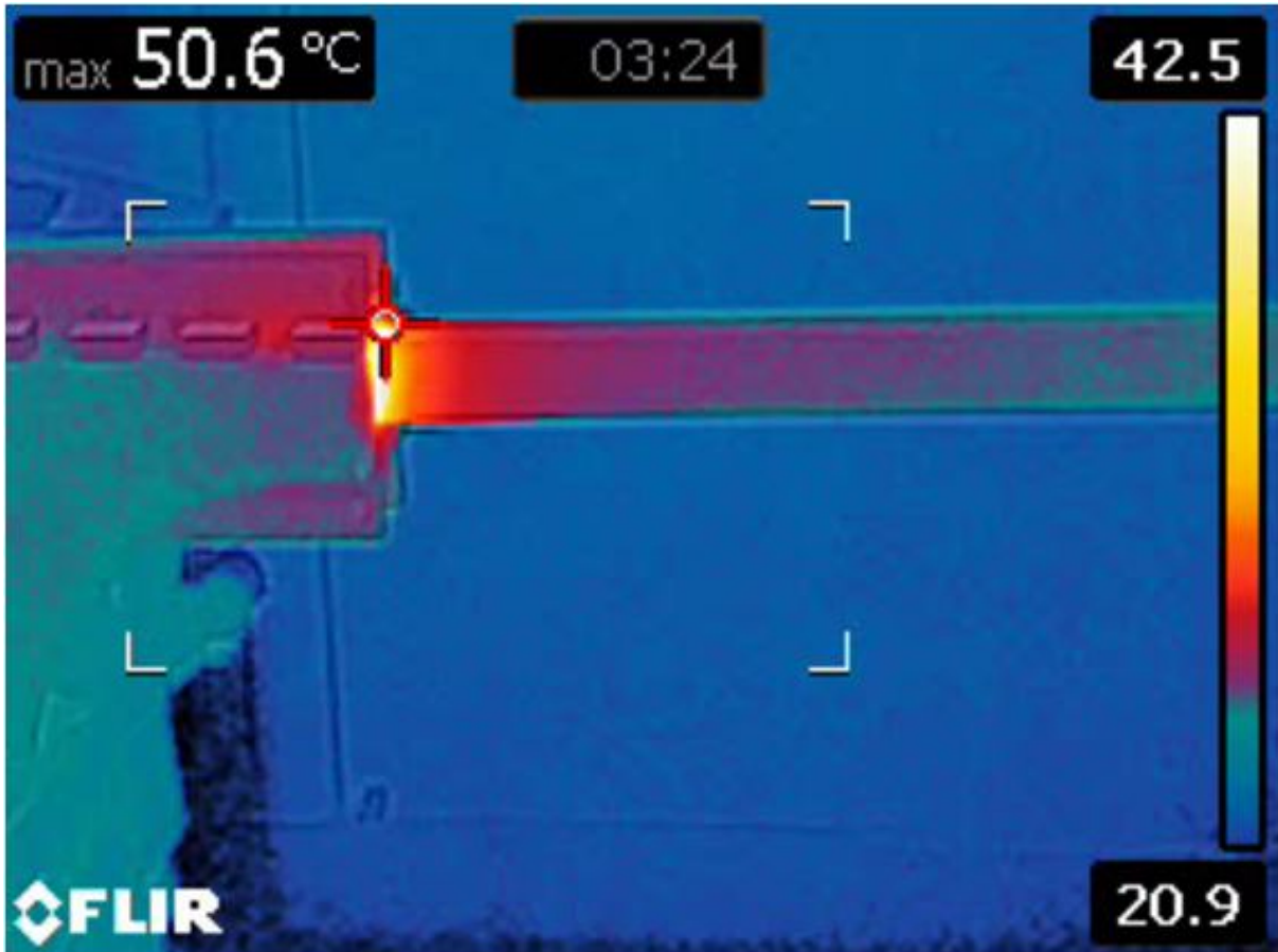
Figura 65 – Mapeamento de temperatura ao longo do ensaio de fadiga.
