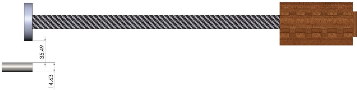
Figura 39 – Distância a ser preenchida pelo came e diâmetro do eixo do motor.
