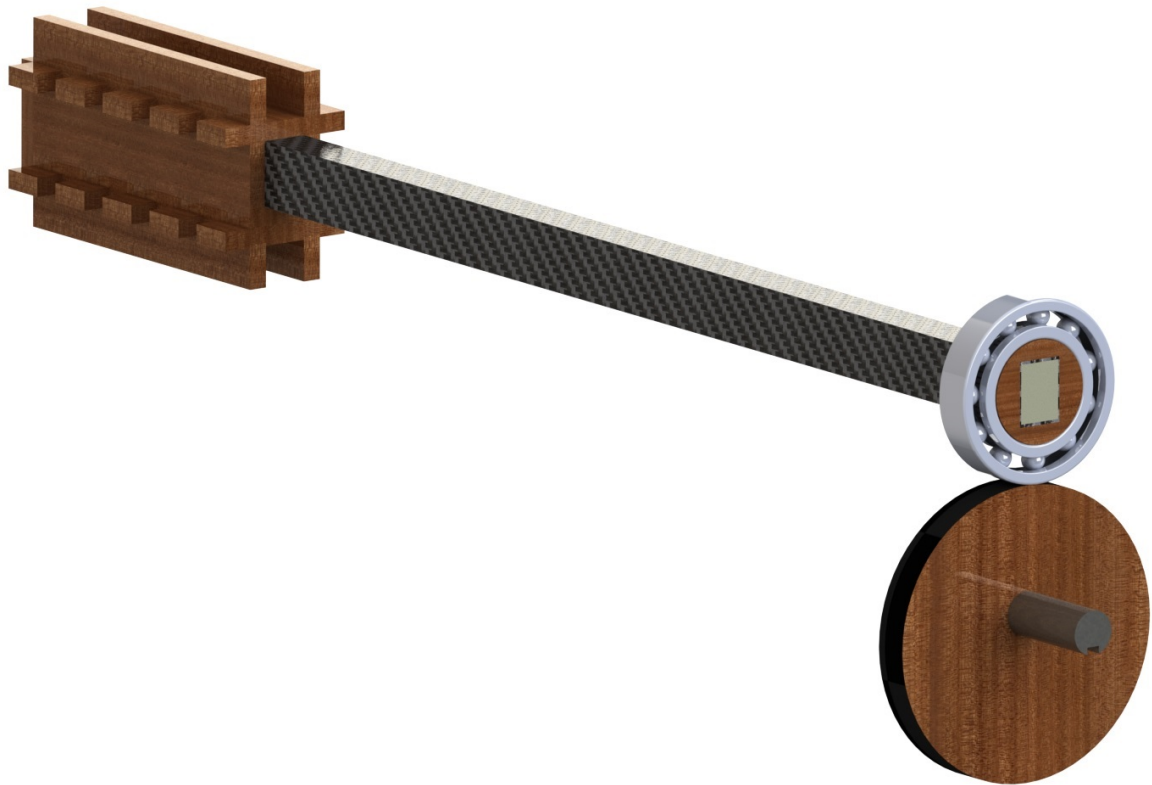
Figura 42 – Sistema do ensaio de fadiga idealizado em CAD.
