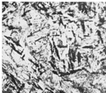
Figura 15: Aspecto microscópico da bainita inferior (formações escuras). Nital 4%. Fonte: (AMERICAN SOCIETY FOR METALS, 1992)
