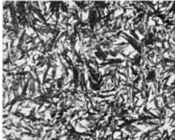
Figura 19: Aspecto microscópico da martensita com 20% da austenita retida (partes claras). Nital 2%. Fonte: (AMERICAN SOCIETY FOR METALS, 1992)
