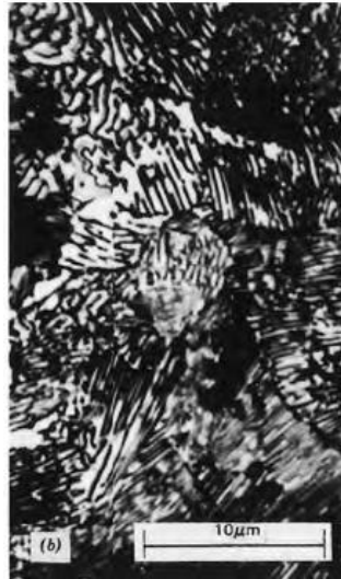
Figura 12: Aspecto microscópico da perlita fina. Fonte: (CALLISTER, 2008)
