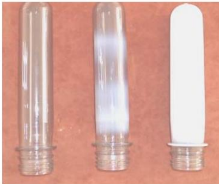
Figura 6: Pré-formas de PET amorfa, parcialmente cristalina e cristalina (da esquerda para direita). Fonte: Estudo da cristalização a frio do poli (tereftalato de etileno) (PET) para produção de embalagens M. S. Rabello e R. M. R. Wellen, 2008.
