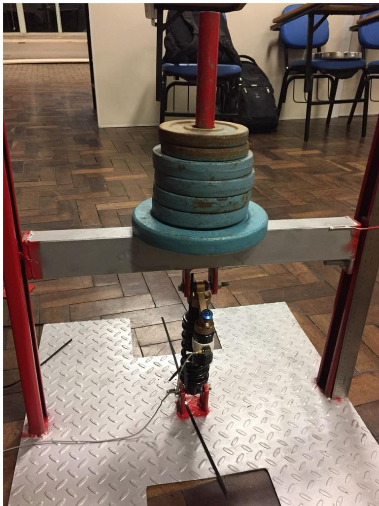
Figura 29 – Medição da carga exercida pela haste móvel
