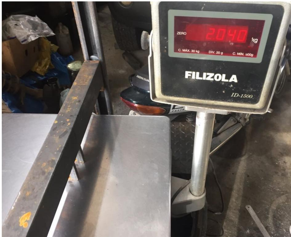
Figura 26 – Medição da carga exercida pela haste móvel
