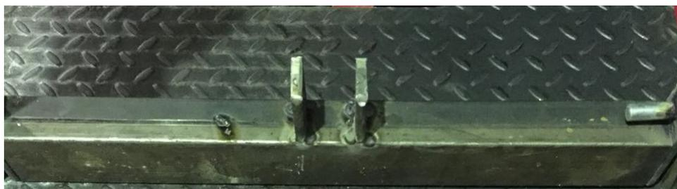
Figura 24 – Abraçadeira ou orelha de fixação do amortecedor na base e haste móvel (ainda em construção)
