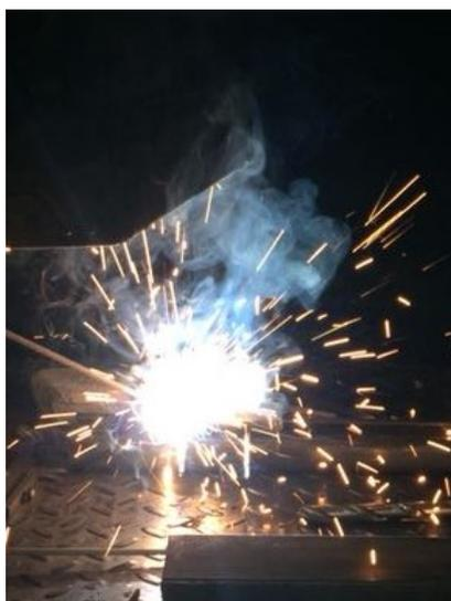
Figura 21 – Soldagem dos rolamentos na haste
