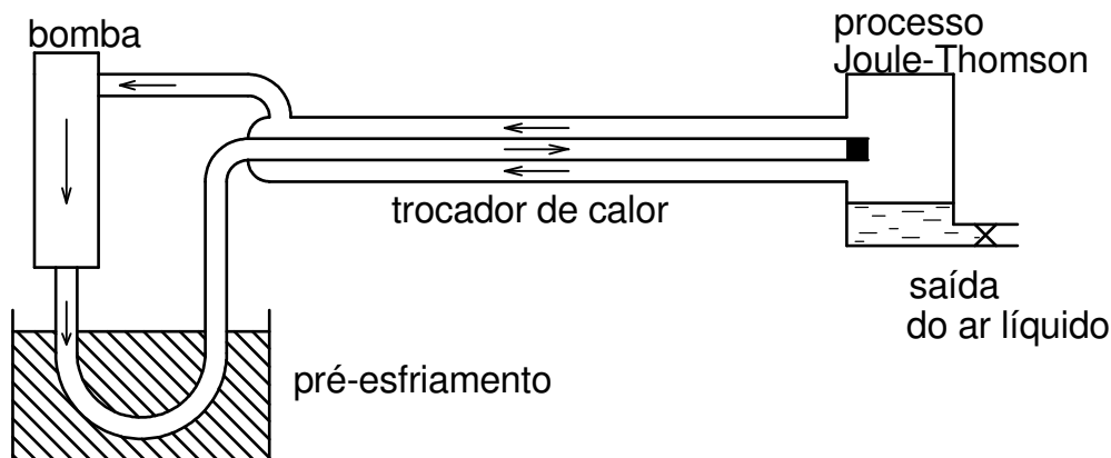
Fig. 7.8 Esquema de uma máquina de liquefazer ar com o processo de Siemens
