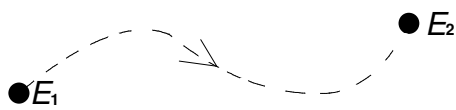
Fig. 3.1 Representação gráfica de um processo que leva o sistema do estado de equilíbrio E_1 , até o estado de equilíbrio E_2 sem passar por estados de equilíbrio
