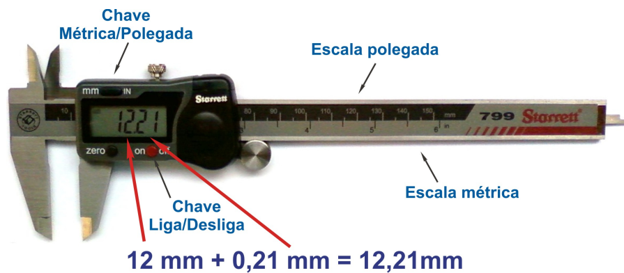
Fig. 6: Fotografia que mostra as partes e um exemplo de leitura de um paquímetro digital do laboratório.
