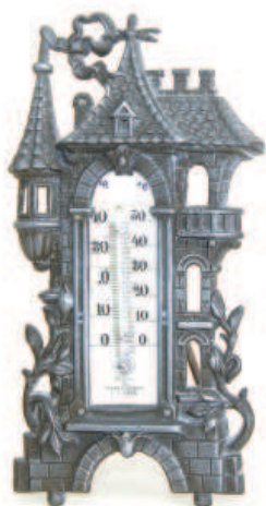
Termômetro com escalas Réaumur e Celsius de temperatura. (Foto: acervo MF/UFJF)
