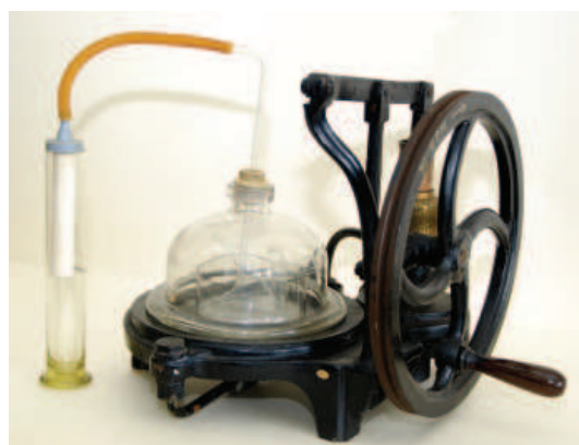
Sistema de filtração de injetáveis e enchimento de ampolas. (Foto: acervo MF/UFJF)
