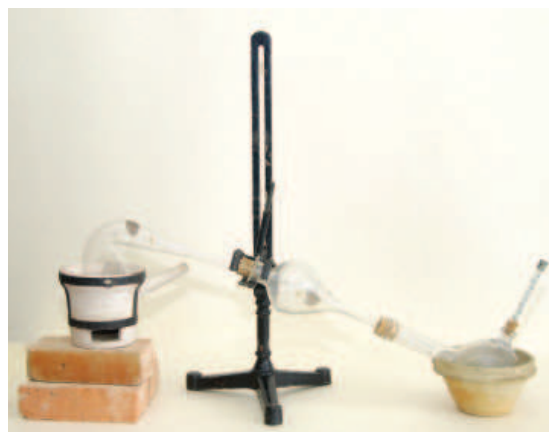
Destilação com retorta. (Foto: acervo MF/UFJF)
