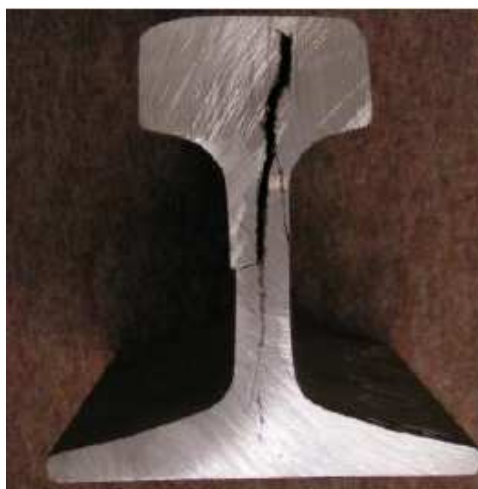
Figura 09 – Trinca transversal Fonte: Petroni (2006)
