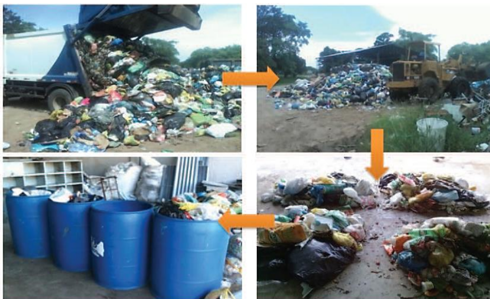
Figura 8 - Etapas envolvidas no processo de estudo da composição gravimétrica dos RSU do Aterro sanitário de Minas do Leão.
