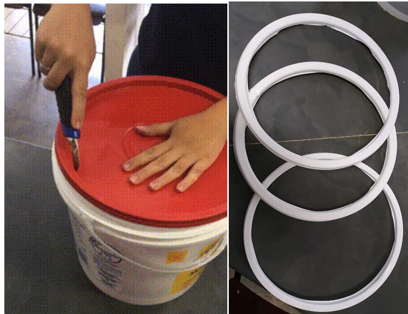
Figura 29 - Corte com estilete das tampas.
