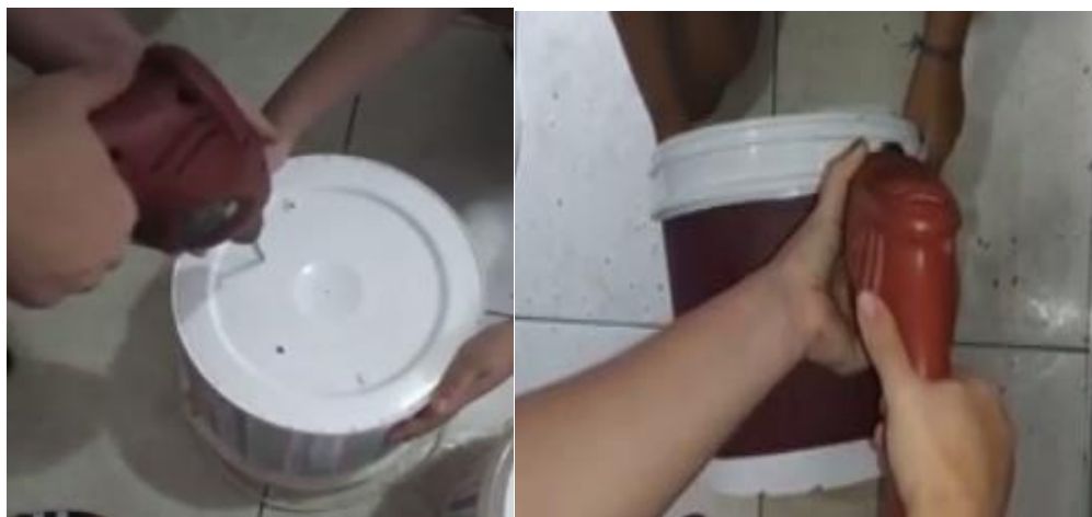
Figura 28 - Furos no fundo e laterais dos baldes.
