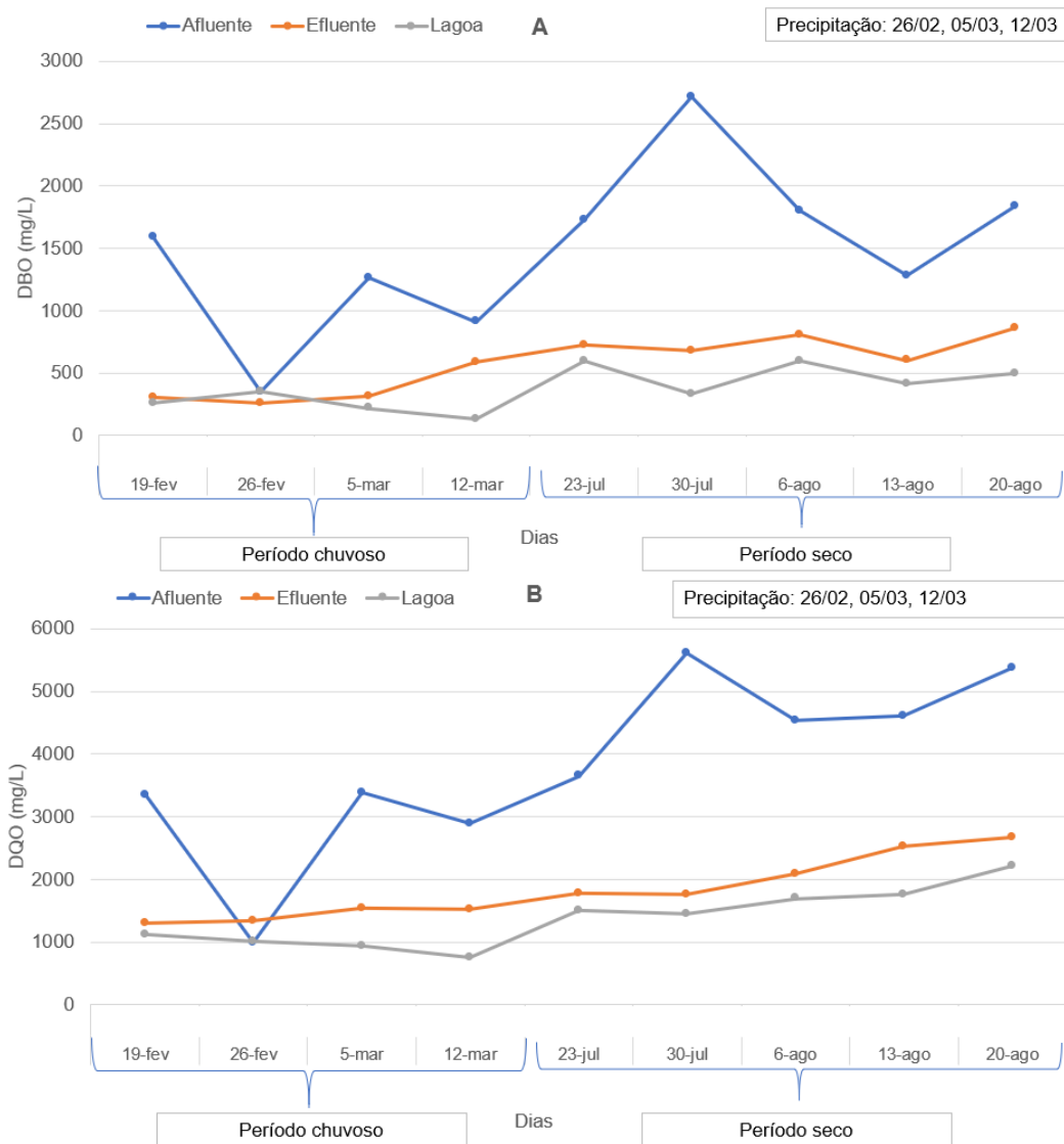
Figura 5.3- Variação temporal da DBO (A) e da DQO (B) durante todo período de monitoramento (2018).
