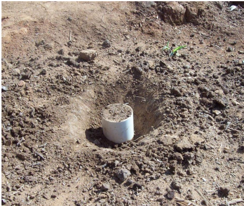
Figura 27: Retirada do cilindro do solo. Fonte: Acervo do autor.
