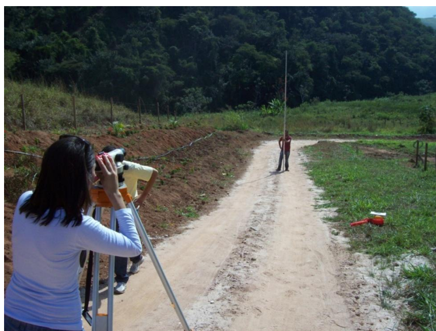
Figura 24: Leitura de Ré do ponto. Fonte: Acervo do autor.
